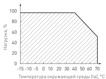
Рис. 2. Максимальная допустимая нагрузка, % от мощности источника
