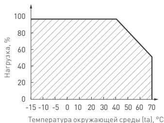
Рис. 2. Максимальная допустимая нагрузка, % от мощности источника
