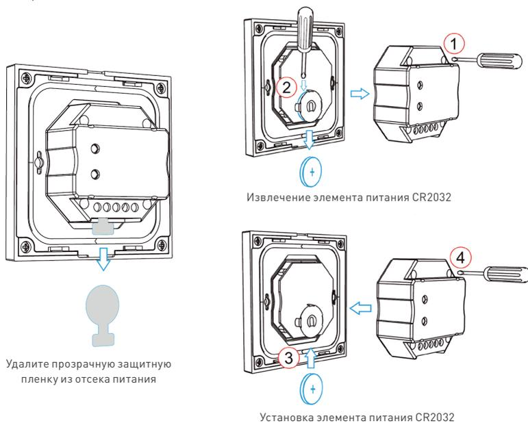
Рисунок 1. Установка элемента питания в панель
