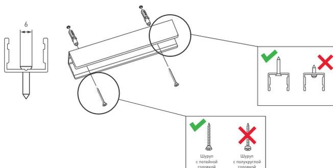
Выбирайте крепеж согласно рекомендациям. Диаметр крепежного отверстия — 3.5 мм. Максимальный диаметр головки шурупа — 6 мм. Используйте шурупы с потайной головкой.
